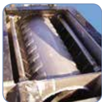
Modulo di compattazione e di drenaggio con sistema di lavaggio (opzione)
