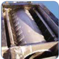
Kompaktierzone am Auslauf mit integriertem Waschsysteem
